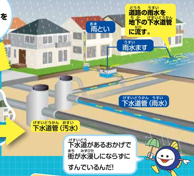
道路の雨水を地下の下水道管に流す。
